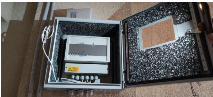
Master im Akustik-Schutzgehäuse
